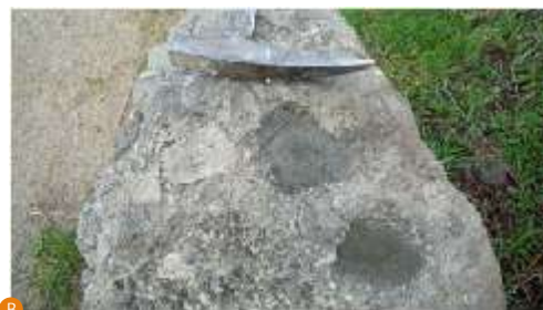
Fig. 26 - A – Construção em alvenaria de brecha magmática. B – Aspetto de uma brecha magmática, onde são evidentes os clastos que a compõem.
